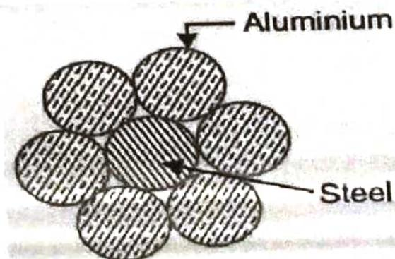
Fig 1.1: ACSR Conductor
